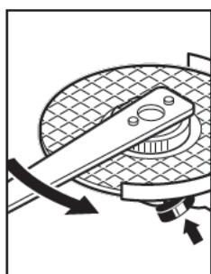
Закрепленную надлежащим способом, неповрежденную быстрозажимную гайку можно открутить вручную, повернув кольцо с накаткой против часовой стрелки. Никогда не откручивайте затянутую быстрозажимную гайку клемшами, используйте комбинированный ключ. Установите комбинированный ключ 5, как изображено на рисунке.
