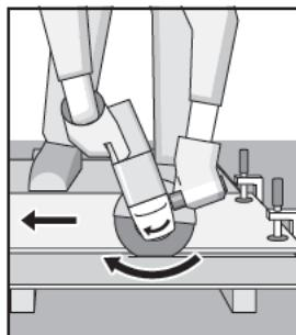
Всегда ведите электроинструмент против направления вращения. В противном случае возникает опасность неконтролируемого выхода из прорези.
