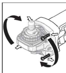
Вы можете повернуть редукторную головку шагами в 90°. Этим выключатель может быть поставлен в удобное для работы положение, например, для левши. Полностью выверните 4 винта. Осторожно поверните редукторную головку **без отрыва от корпуса** в новое положение. Крепко затяните 4 винта.
