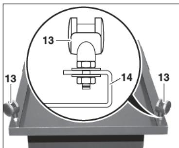
Установить шайбу 8,4 на шпильку на направляющем ролике (13). Вставить направляющий ролик (13) шайбой в имеющиеся отверстия на опорной плите (14). Установить шайбу 8,4 и шестигранную гайку M8. Затянуть шестигранную гайку гаечным ключом SW 13 мм. При этом придерживать направляю-
