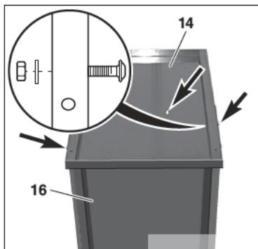
Установить стойку (16) выемкой вниз. Уложить сверху опорную плиту (14) и зафиксировать 5 винтами с внутренним шестигранником M6x16, шайбами 6,4 и шестигранными гайками M6 согл. рис. Для закрепления резьбовых соединений использовать торцевой гаечный ключ SW 10 мм и отвертку для винтов с внутренним шестигранником SW 4 мм.
