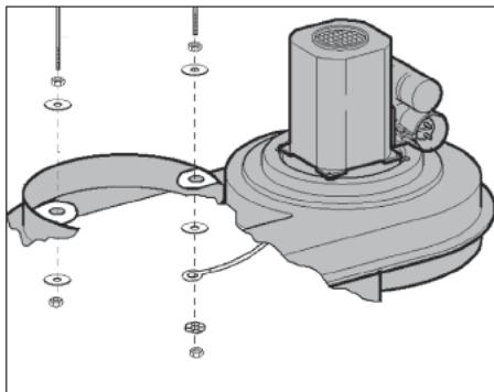
Накрутить шестигранные гайки М6 до середины резьбы на хомуте фильтра (2). Надеть шайбы 6,4 и вставить хомут фильтра (2) в имеющиеся отверстия на пылеудаляющем устройстве (6).
