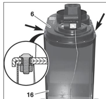
Установить стойку (16) с опорной плитой на рабочие колеса. Уложить пылеудаляющее устройство (6) на стойку (16) и выровнять. Вставить 4 винта с внутренним шестигранником M6x16 сверху в имеющиеся отверстия и закрепить отверткой SW 4.
