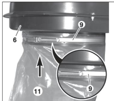
Надеть стяжной хомут (9) на мешок для стружки (11). Надеть стяжной хомут с мешком на патрубок с нижней стороны пылеудаляющего устройства (6). Следить за тем, чтобы мешок для стружки (11) полностью находился на патрубке пылеудаляющего устройства (6) и под стяжным хомутом. Стяжной хомут выровнять таким образом, чтобы он полностью прилегал к серой полоске из пенопласта. Закрепить стяжной хомут (9), перекинув запорный рычаг.
