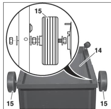
Надеть колесо (15) с двумя шайбами 8,4 на винт с шестигранной головкой M8x60 и закрепить шестигранную гайку M8 таким образом, чтобы колесо (15) легко вращалось между шайбами на винте с шестигранной головкой. Установить шайбу 8,4 на винт с шестигранной головкой с предварительно установленным колесом (15). Вставить винт с шестигранной головкой в боковые отверстия в опорной плите (14) и закрепить шайбы 8,4 и шестигранную гайку. В соотв. с рисунком запрессовать накладку на колесо до ощущения щелчка.
